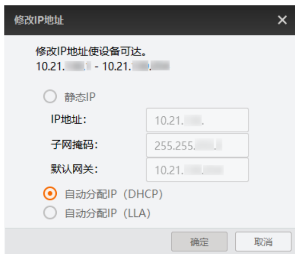
图3-14 修改 IP 地址
